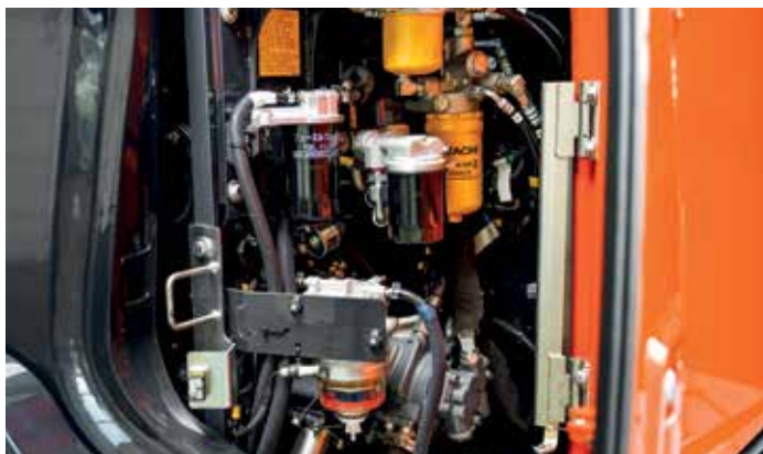
Gemakkelijke toegang tot alle filters, die zich bij elkaar in één compartiment bevinden.
