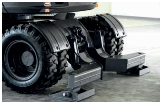
De onafhankelijk bedienbare stempels vergroten de stabiliteit.
