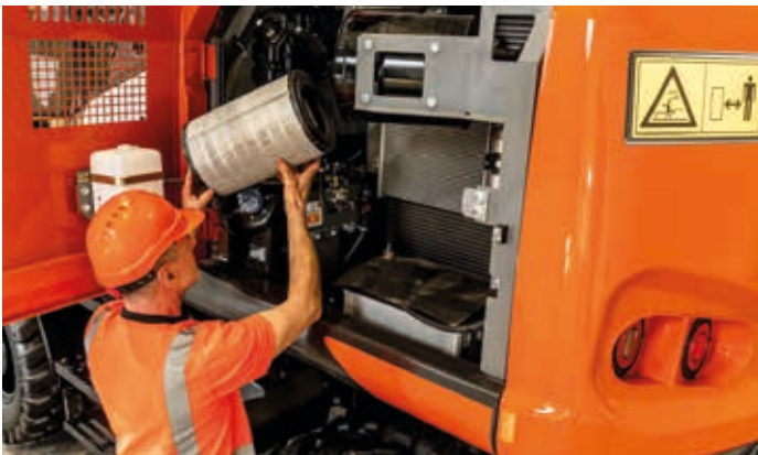
Onderhoud is eenvoudig mogelijk vanaf de grond.
