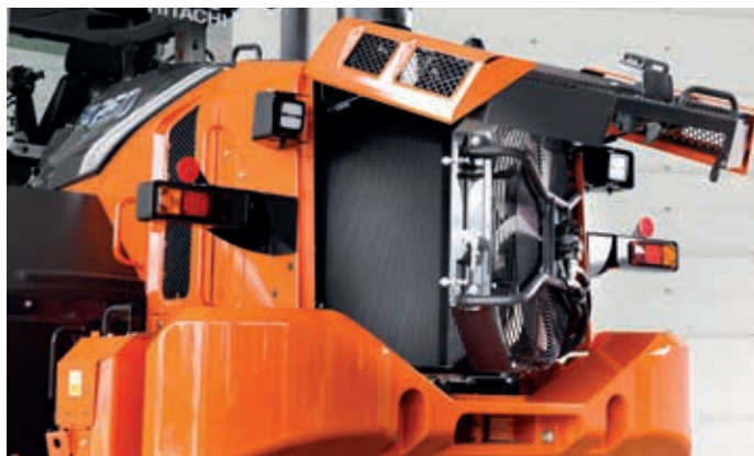
De instelbare omkeerbare ventilator voorkomt verstopping van de radiateurs.
