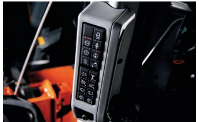
Elk van de meest gebruikte functies kunt u in een oogwenk selecteren op het schakelpaneel aan de zijkant.
