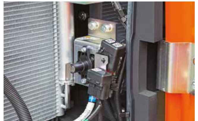
De massaschakelaar zorgt ervoor dat onderhoud veilig kan worden uitgevoerd.
