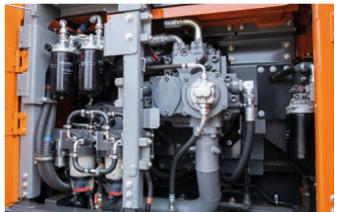
Het HIOS V hydraulische systeem biedt tot 22 % brandstofbesparing.
