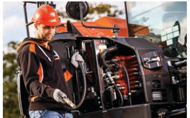
De brandstoftank van de graafmachine kan met een elektrische pomp worden bijgevuld.
