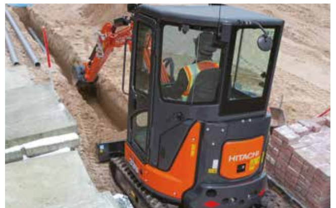
De korte draaicirkel van de ZX33U-6 is ideaal voor gebruik op kleine werklocaties.
