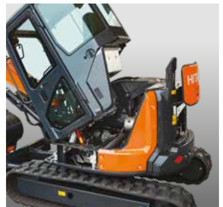
De kantelende vloer zorgt voor eenvoudige toegang tot de motor en regelklep, zodat servicewerkzaamheden snel kunnen worden uitgevoerd.
