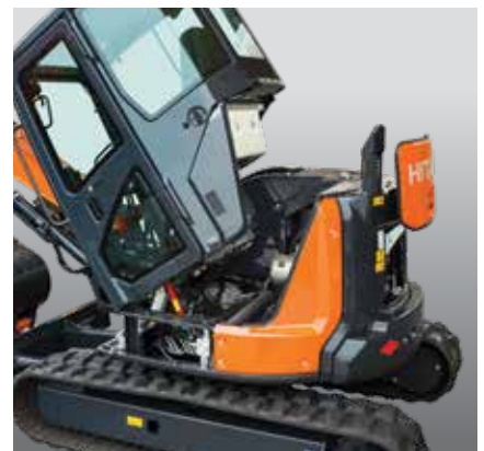
De kantelbare cabine zorgt voor eenvoudige toegang tot de motor en ventielenblok, zodat servicewerkzaamheden snel kunnen worden uitgevoerd.
