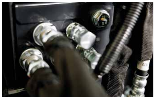
Snelwisselaansluiting (optioneel) onder gereedschapskist maakt veilige installatie achteraf mogelijk.
