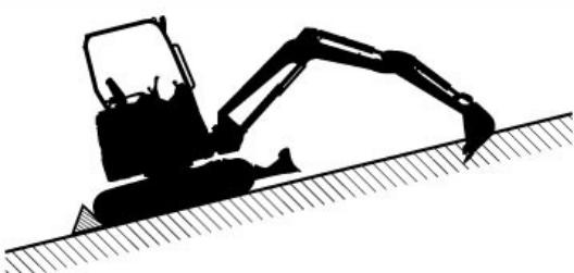
バケット、ブレードは地面に下ろしましょう。止むを得ず傾斜地で停める時はクローラに歯止めもかける。
