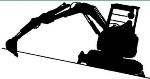
バケット、ブレードは地面に下ろしましょう。止むを得ず傾斜地で停める時はクローラに歯止めかける。
