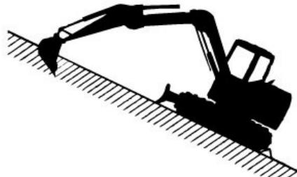
バケット、ブレードは地面に下ろしましょう。止むを得ず傾斜地で停める時はクローラに歯止めもかける。
