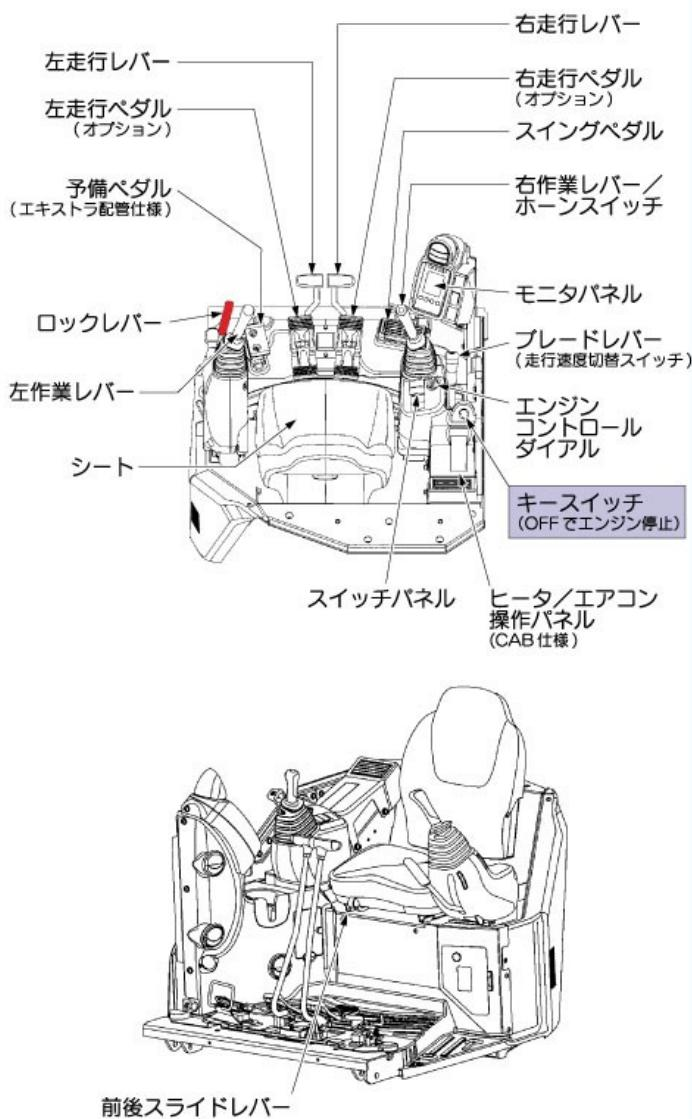
**モニターパネルおよびスイッチ類の操作**
