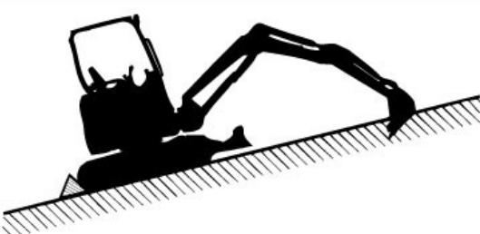
バケット、ブレードは地面に下ろしましょう。止むを得ず傾斜地で停める時はクローラに歯止めもかける。
